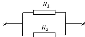
1)  $R_1 R_2 / (R_1 + R_2)$
